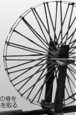
筋入機 うちわを通して骨筋を出す
