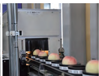
最新鋭の光センサーで、桃の糖度だけでなく、硬度や果肉障害の有無など、総合的に果実を測定できます
