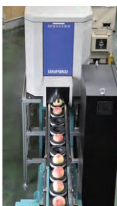
最新鋭の光センサーで、桃の糖度だけでなく、硬度や果肉障害の有無など、総合的に果実を測定できます
